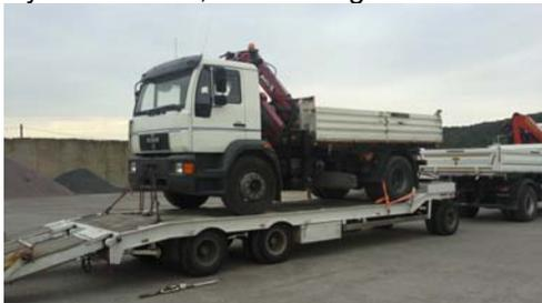
42-315 1 Tieflader Müller Mittelal - T3, 3-Achser, mit hydr. 2-teiligen Rampen, Bj. 1980, 40er-Zugöse, Beplankung-Eiche 2010 neu, Reifen ständig erneuert, Lackierung 2011 neu, voll funktionstüchtig, techn. zulässiges Gesamtgewicht 30t, zul. Gesamtgewicht 24t
