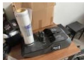
1 Luftpolstermaschine, Fabr. AF, Typ AF400, zum Erstellen von Polstermaterial (Bsp.: Versand), Durchsatz 4 m pro Minute 16 10.00 10.02.2026
