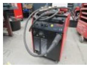
1 MIG/MAG Schweißgerät, Fabr. Würth Master, Typ MM 350, Artikel-Nr. 5952 352 351, mit 1 Schlauchpaket, Griffstück und Druckminderer 7 300.00 06.02.2026 10:06 Uhr
